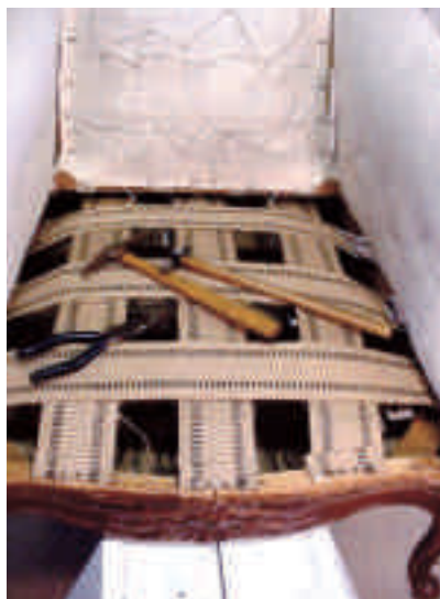
Vendosja e rripave (kollanëve) në konstruktion të drurit
