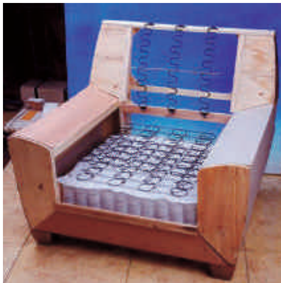
Shtresa e kombinuar nga bërthama e telit dhe spirale për tërheqje
