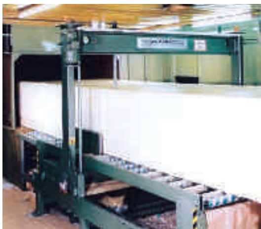
Makineri për prerjen e shkumës së butë poliuretanike
